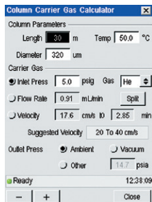
内置流量计算器可计算给定长度和直径色谱柱的流速。
