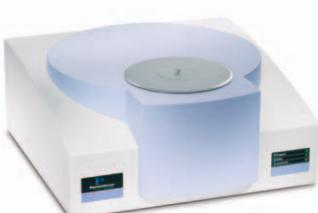
如果您认为测试效率是非常关键的，STA6000 的立式设计装换样品非常方便，另外，可选配45位的自动进样器进行自动测试。
