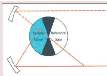
整个光学系统全部采用涂有 $\text{SiO}_2$ 保护层的反射光学元件,使用高质量的母刻全息光栅,紫外/可见光栅刻线密度为1440条/mm,近红外光栅刻线密度为360条/mm;采用最先进的四区分段扇形信号收集斩波器,斩波器运转期间,样品和参比的信号分别单独被各自的黑区信号所分隔并校正,确保了每次得到最准确的样品和参比的信号,紫外/可见区波长精度达到 0.025nm。
