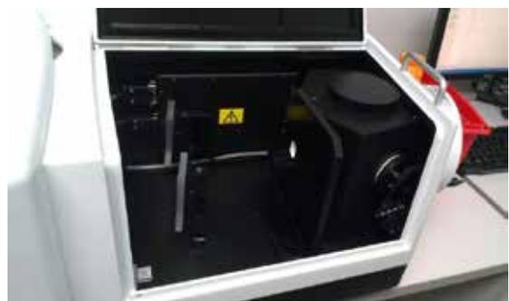
图2. 150mm积分球及接触镜测试套件
