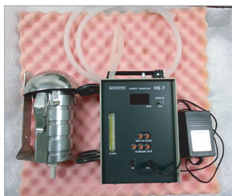
图1a. 真空泵和阶式碰撞取样器图
